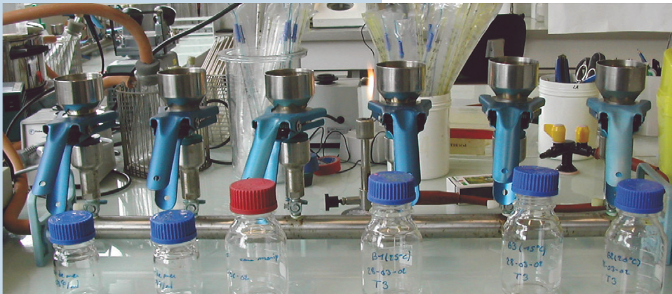
Filtration d'échantillons en vue de l'analyse de traceurs de sources microbiennes
